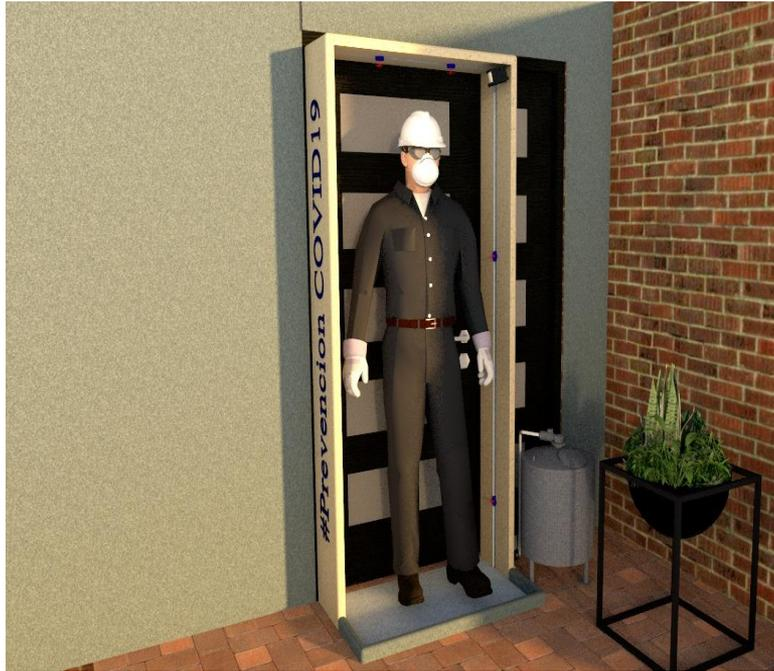
El funcionamiento será mediante el pulsado de un botón que permitirá el accionamiento de la bomba, y así el fluido fluya por la tubería expulsando por los aspersores la disolución para desinfectar al usuario. Se puede observar que funciona de cuerpo entero, abarcando una zona para desinfección de zapatos y pies, existiendo así un proceso completo de desinfección que satisface completamente al usuario.
