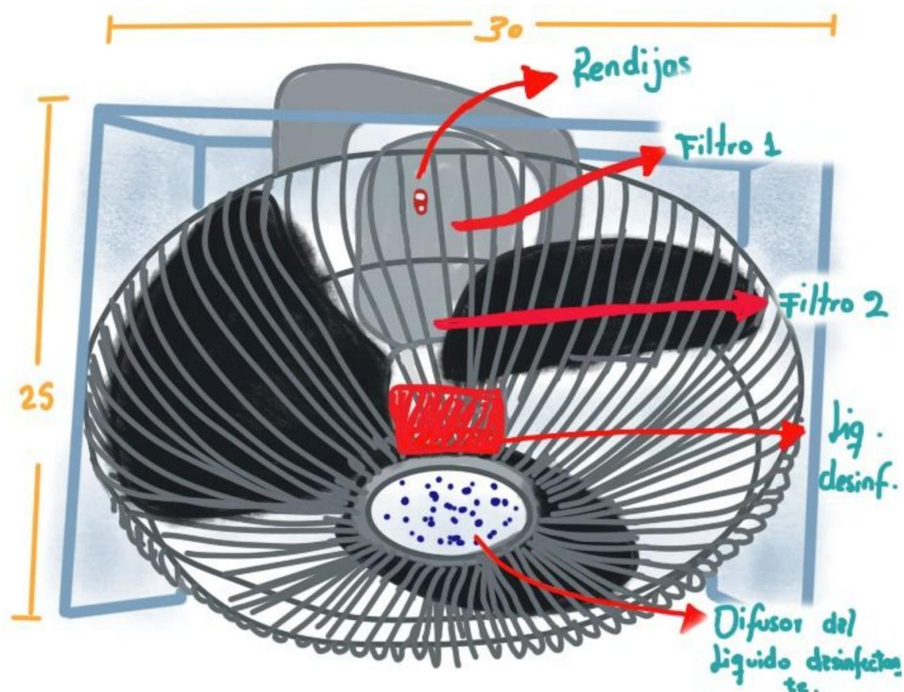
Se agrega el líquido desinfectante a tu preferencia al contenedor, verificar el filtro intercambiable y luego encender el equipo, regulando la potencia deseada para el esparcimiento homogéneo del líquido en el espacio a desinfectar.
