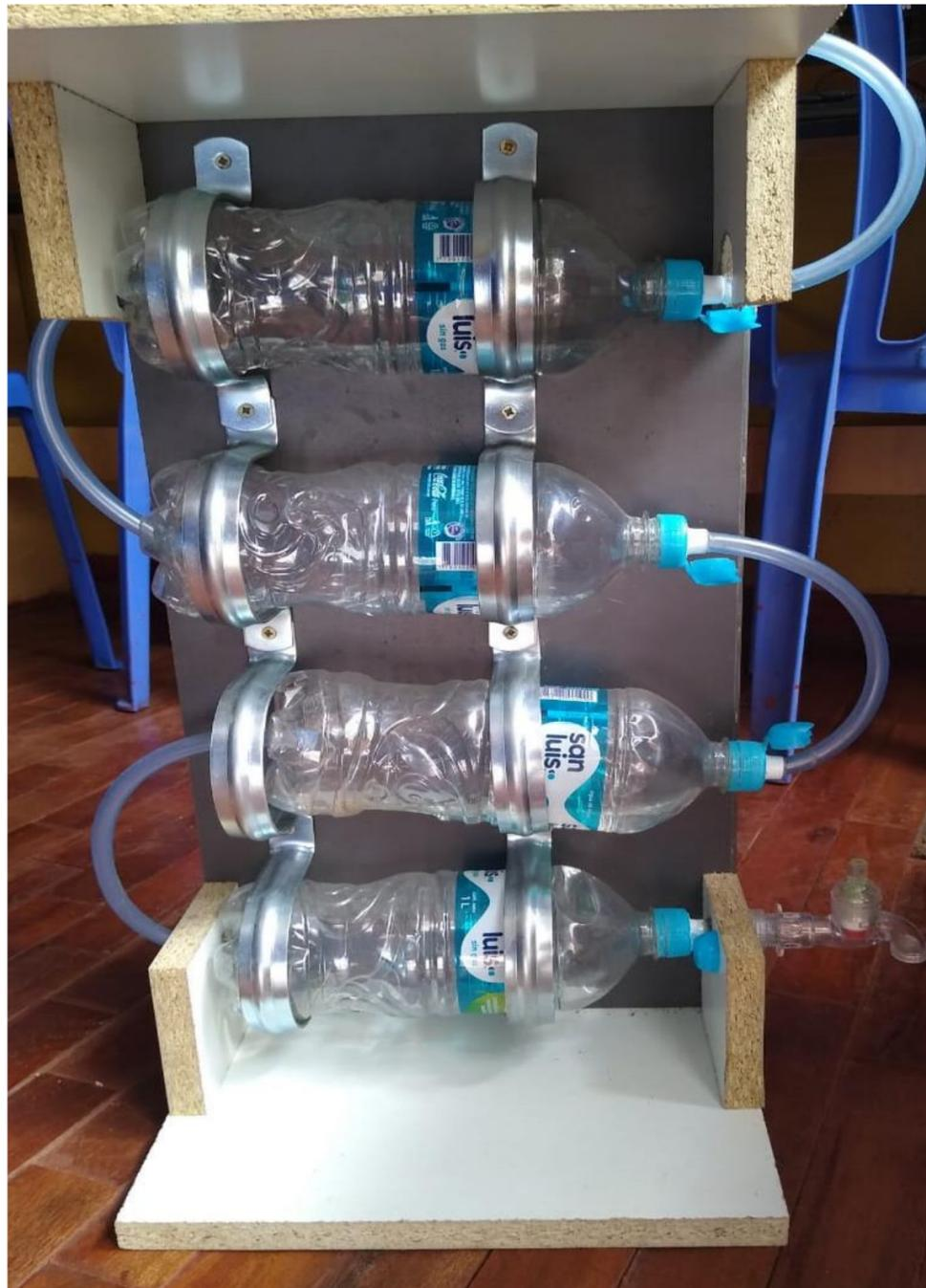
Recolectar el agua (agua de lluvia o agua potable) para poder ponerlo en un bidón y este ser conectado a una serie de tubos y botellas de plástico como filtrador este para que el agua pase y por medio de los rayos solares eliminen las bacterias sensibles y por otro lado recibir el agua filtrada limpia.
