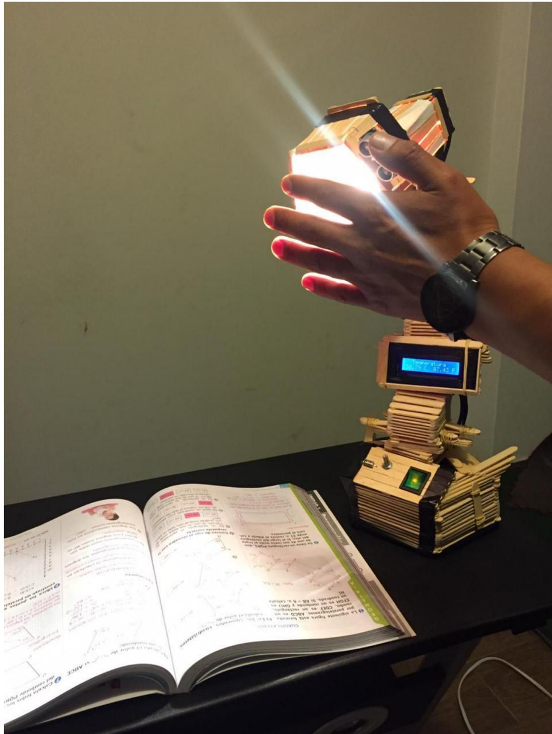
Conectas la lámpara, una vez conectada presionas el botón de encendido, para activar el sensor de movimiento pasas la mano por debajo del foco y este se moverá. También puedes regular la intensidad de la luz con solo girar un botón.
