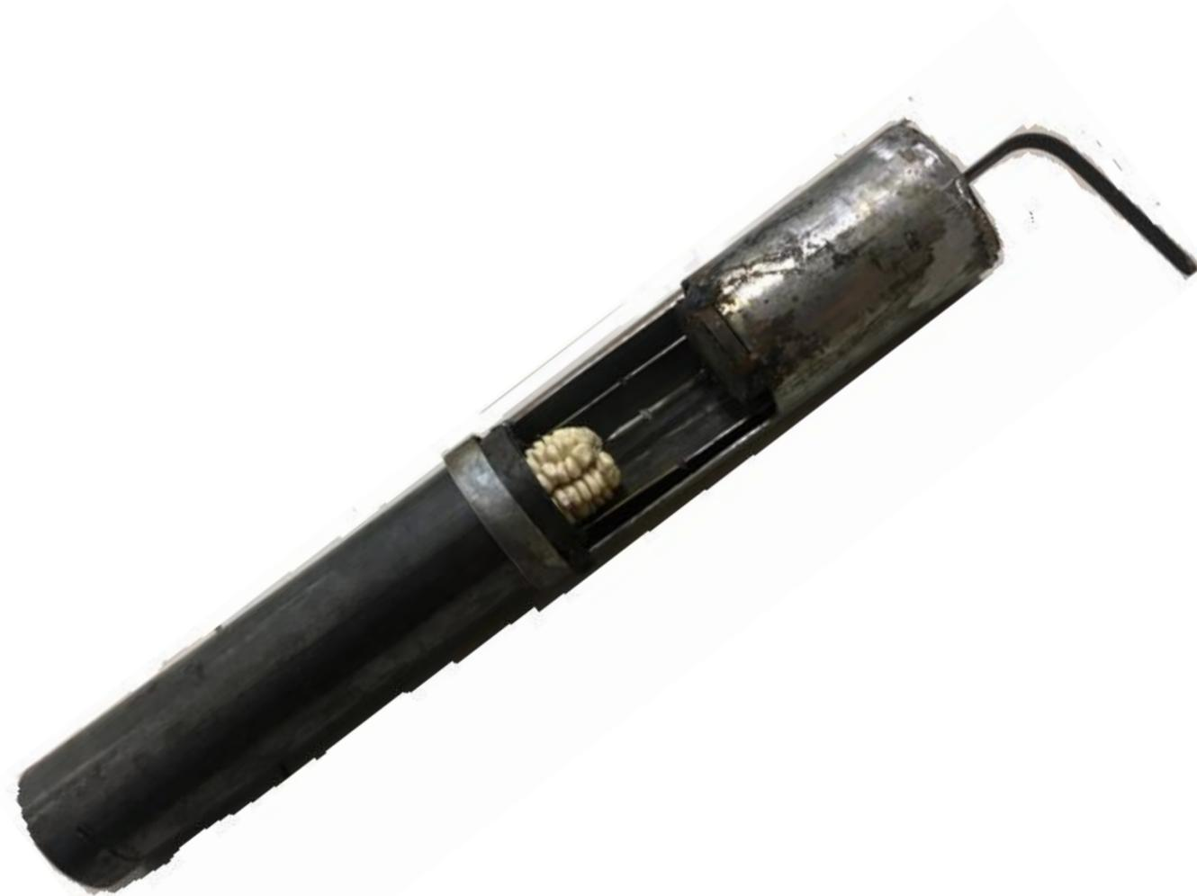
Enciendes el equipo, introduces la mazorca de maíz en el compartimiento, con la manija empujas el maíz, y gracias a la fuerza mecánica del motor el equipo comienza a desgranar el maíz en 5 segundos.
