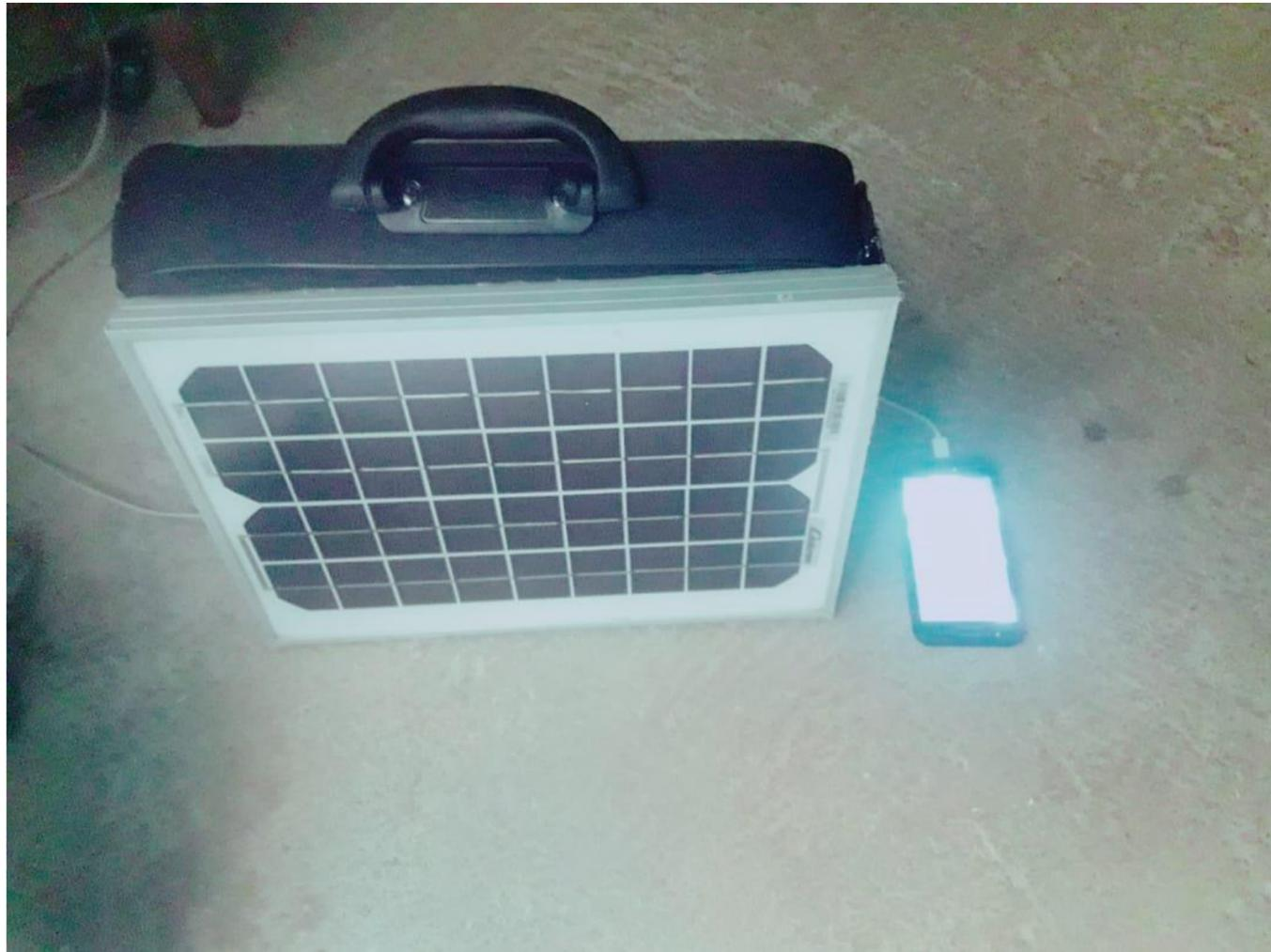
El cargador solar portátil consta de un inversor, el panel solar, batería y circuitos, en la cual el panel absorberá energía del sol, la batería guardará energía si se quiere utilizar en la noche, el controlador de voltios hará que se distribuya la correcta energía hacia el artefacto luego pasa al inversor para transferir la energía al celular o laptop.
