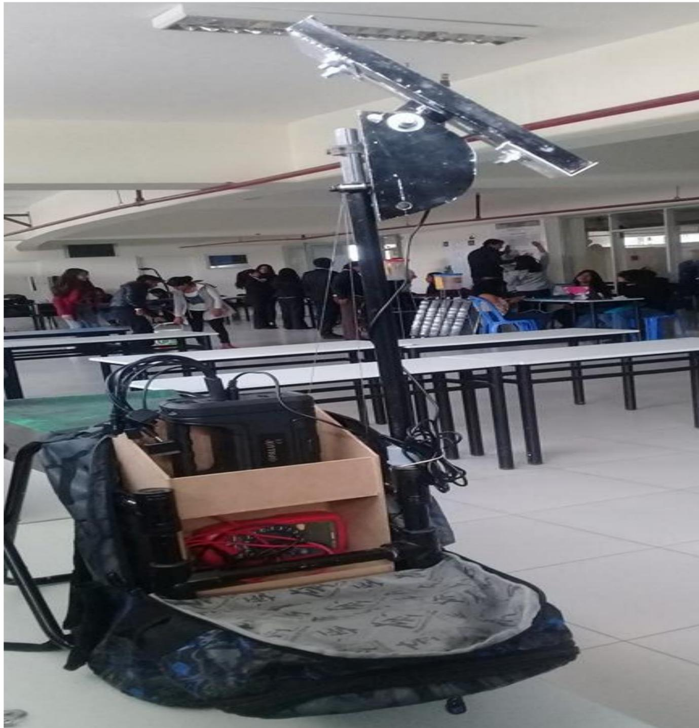
Este prototipo permitirá a los investigadores ambientales recopilar o hacer toma de datos en el campo, esta mochila usara energía solar, la captación de esta energía será por medio de un panel solar.
