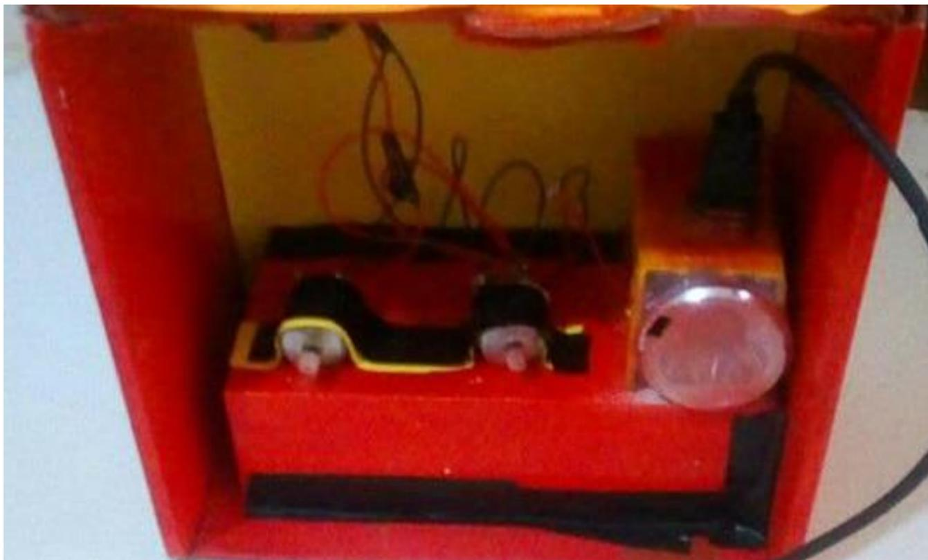
El prototipo cuenta con pequeño motor que brindara energía junto con el condensador y para reforzar la energía con una bobina y ventilador, esta conectado con cables por el cual estará conectado a una entrada USB para cargar aparatos eléctricos y una linterna que nos brindara iluminación.
