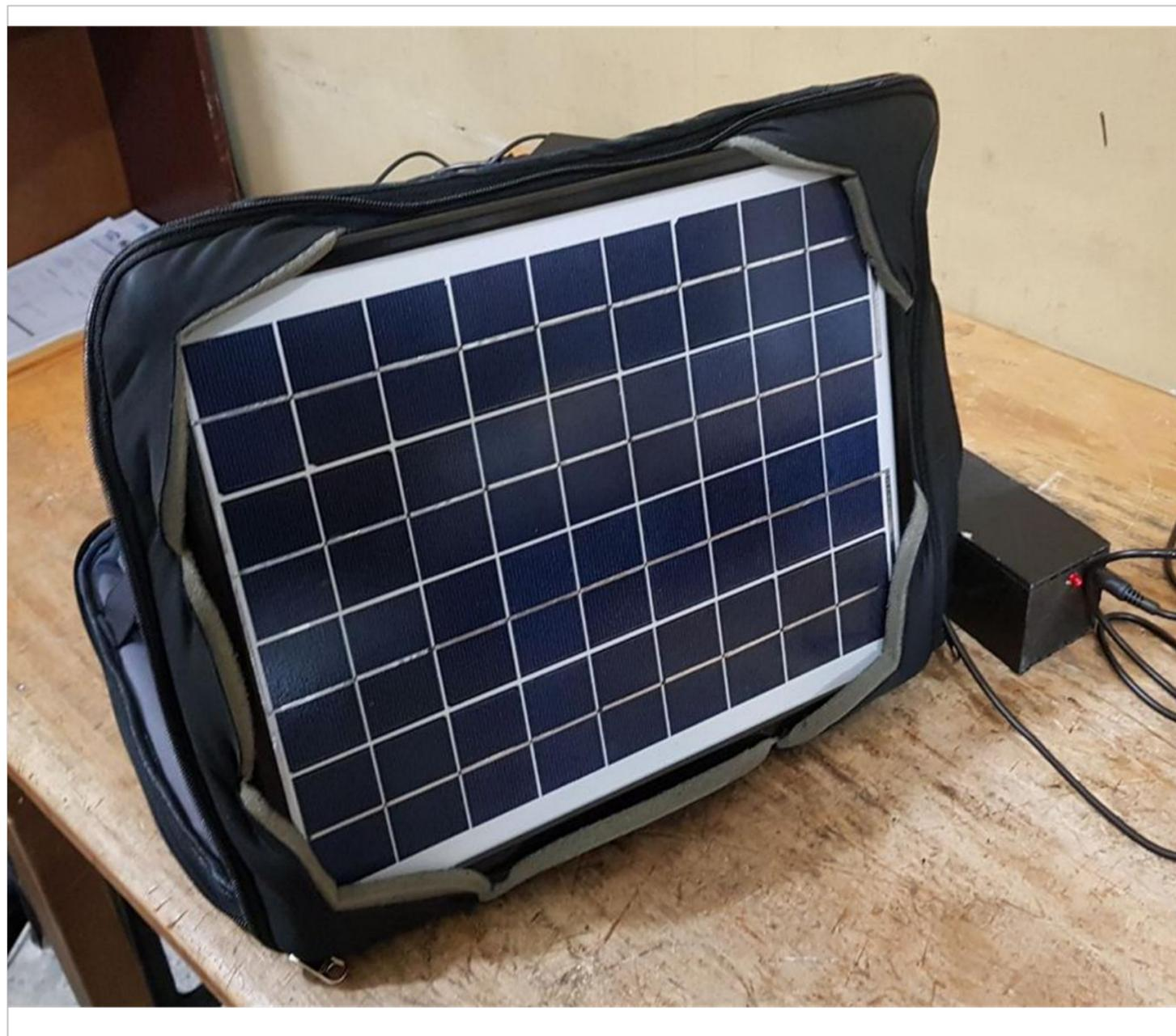
El producto consta de un panel solar incorporado en un estuche de laptop para no desperdiciar espacio que este panel nos pueda ocupar. también consta de una batería que sirve de almacén de la energía solar captada por el panel. A su vez esta batería también se puede cargar de la laptop para que en el caso de que no capte energía solar esta se pueda cargar de esa manera.
