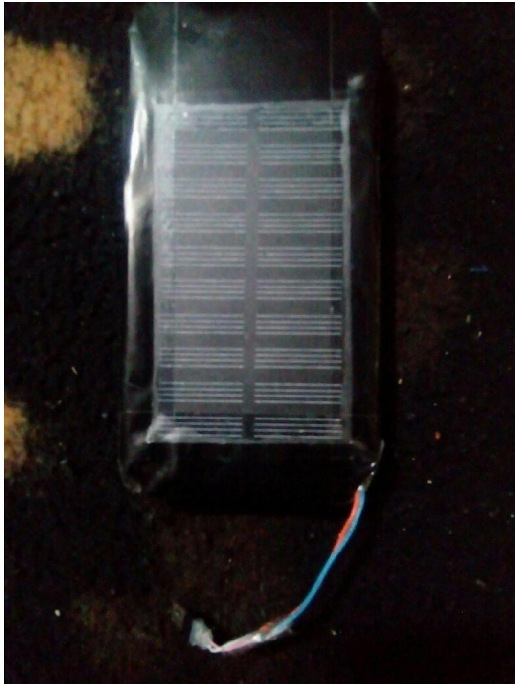
Este prototipo muestra la idea de un grupo de estudiantes innovadores, pues trata de un protector de celular con energía renovable que incluye un panel solar y una batería de litio donde se pueda almacenar energía en el momento que no refleje el sol, así se pueda cargar el móvil en cualquier momento del día.
