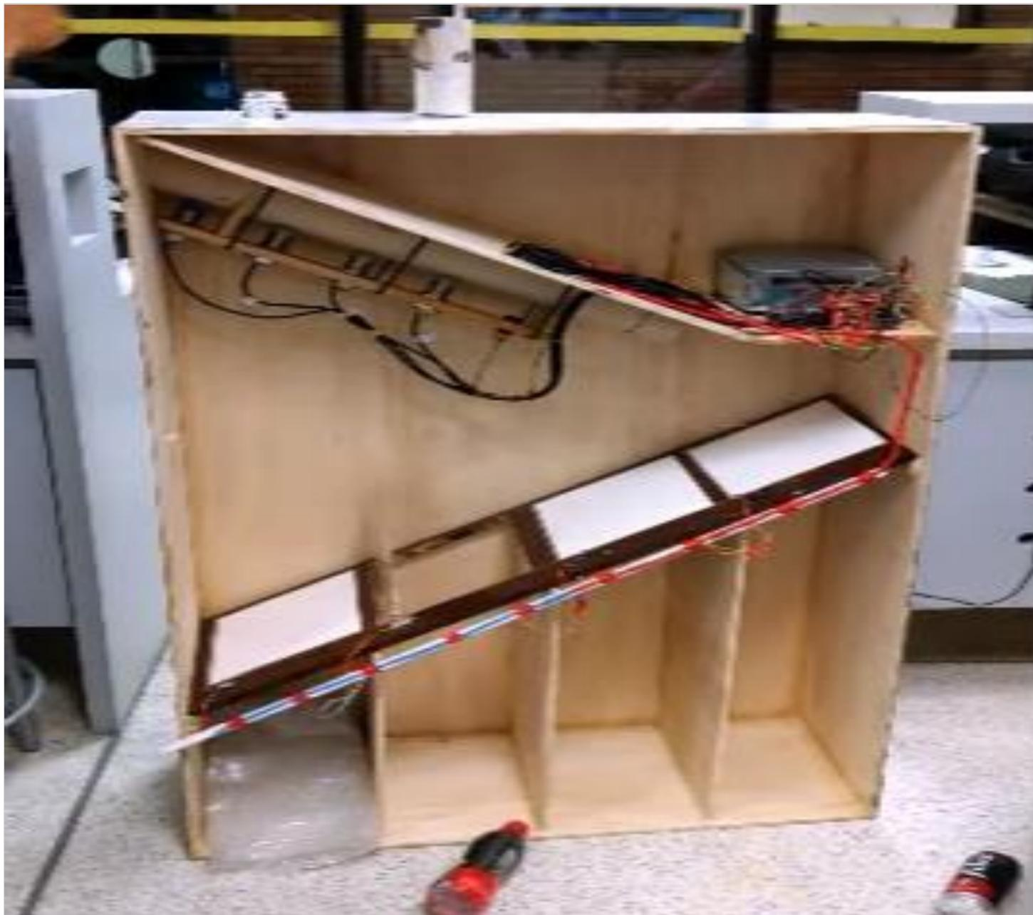
Es una maquina que trabaja con distintos tipos de sensores, separando distintos tipos de residuos (metales, plástico, vidrio, papel).
